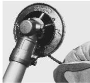
ナイロンコードが摩耗したら、差し込んだ反対の穴からコードを引き抜き、新しいコードと交換して
