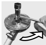
刈払機に使用しているボルト（またはナット）で締め付けます。ほとんどの刈払機で締まる方向が通常
